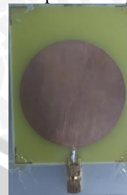
Gambar 16 Antena mikrostrip circular patch dengan teknik pencatutan microstrip line-feed (Sumber: Fabrikasi)
