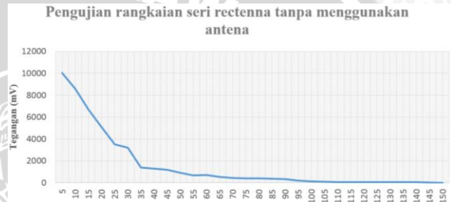
Gambar 31 Grafik pengujian output DC rangkaian seri rectenna tanpa menggunakan antenna (Sumber : Pengujian)
