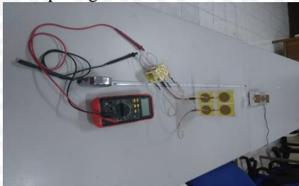
Gambar 34 Pengujian rangkaian seri rectenna pada transmitter antenna yang digunakan antenna mikrostrip star patch with additional elliptical shape . Grafik hasil pengujian dapat dilihat pada gambar 35.
