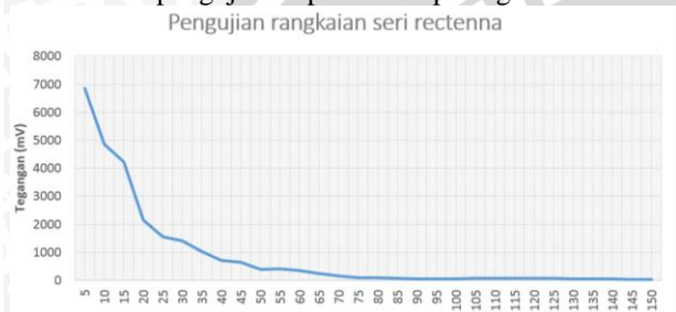
Gambar 35 Grafik pengujian rangkaian seri rectenna pada transmitter menggunakan antenna mikrostrip star patch with additional elliptical shape (Sumber: Pengujian)
