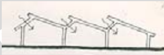
Gambar 2.15 Atap gergaji pada bangunan pabrik sumber : www.arcdaily.com
