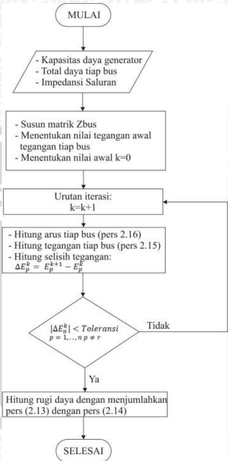
Gambar 2.1 Diagram Alir Langkah-langkah Perhitungan *Gauss Seidel Zbus*
