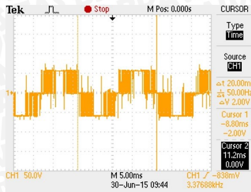
Gambar 5.10 Sinyal yang dihasilkan oleh full bridge MOSFET V/div=50 volt dan time/div=5 ms
