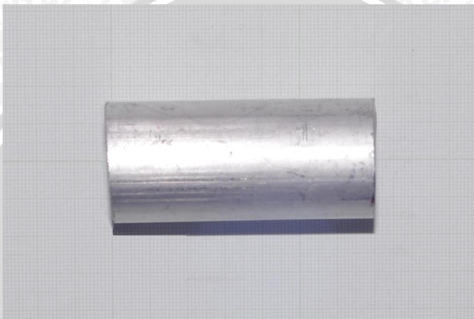
Gambar 3.7 Benda kerja aluminium 6061
