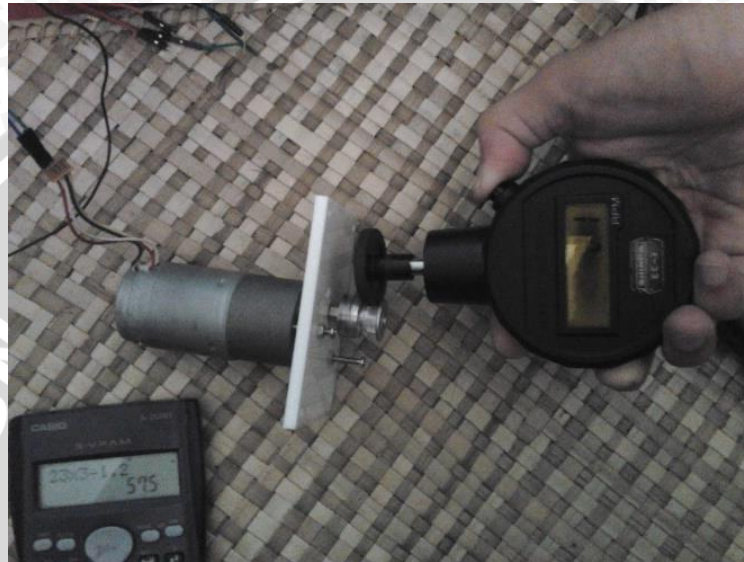
Gambar 5.5 Pengujian kecepatan motor
