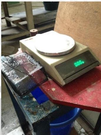
Gambar 4.1 Alat pengujian *apparent density* dengan metode piknometri
