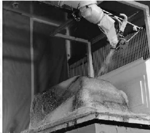
Gambar 2.16 Proses Spray-up dengan menggunakan robot Sumber : Mazumdar (2002)
