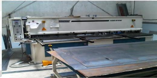
Gambar 3.6 : Mesin pemotong pelat
