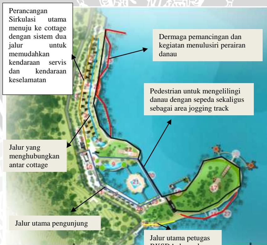
**Gambar 4.103** Jalur Sirkulasi Masing-Masing Pengguna
