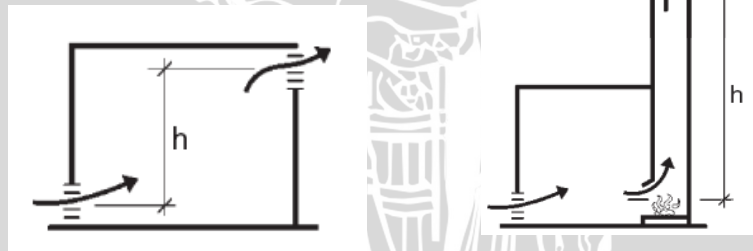
Gambar 2.28 Stack effect pada ruang dan cerobong Sumber: Szokolay 2004
