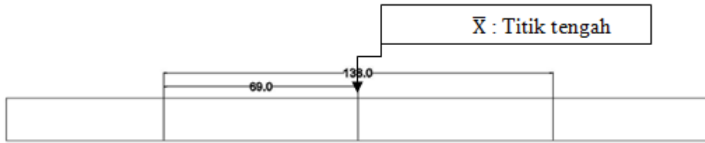
Gambar 3. 19 Titik tengah patahan spesimen
