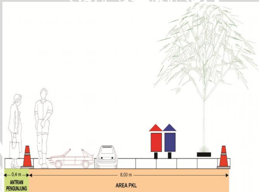
Gambar 4.47 Arahan Dimensi Ruang Alat/ Sarana Berdagang Gelaran (Tampak Depan)
