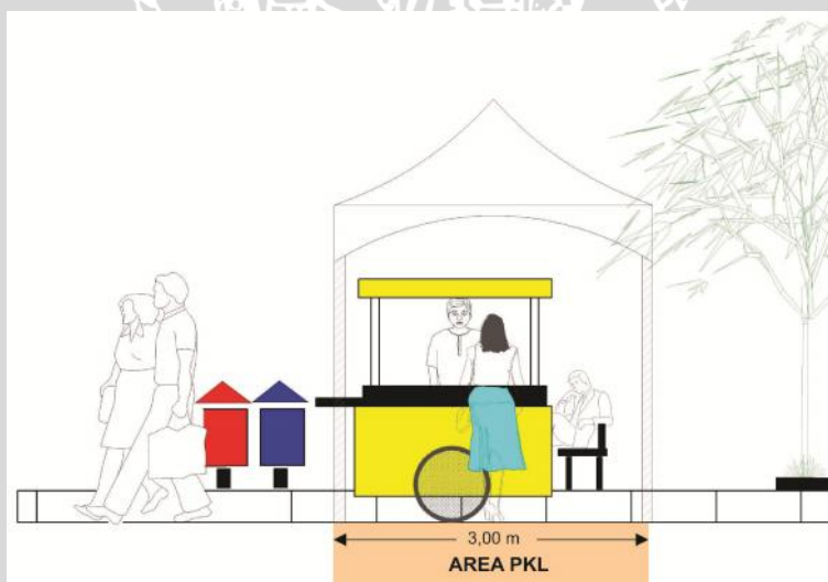
Gambar 4.39 Arahan Dimensi Ruang Alat/ Sarana Berdagang Jenis Tenda (Tampak Depan)
