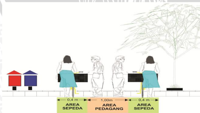
Gambar 4.49 Arahan Dimensi Ruang Alat/ Sarana Berdagang Sepeda (Tampak Depan)
