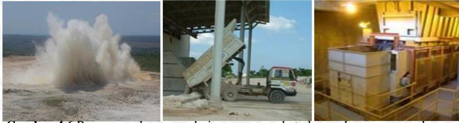
**Gambar 4.6** Proses penghancuran dari pegunungan batu kapur dan proses crusher
