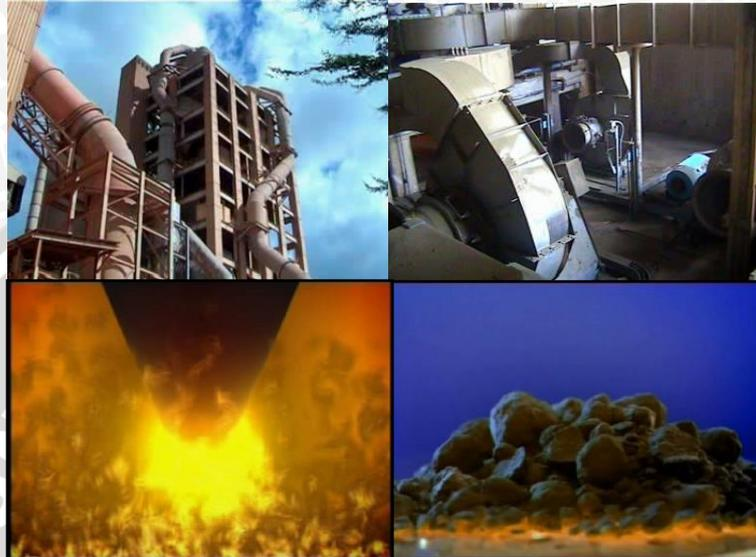
**Gambar 4.8** Proses Pemanasan Tahap awal dengan Kiln
