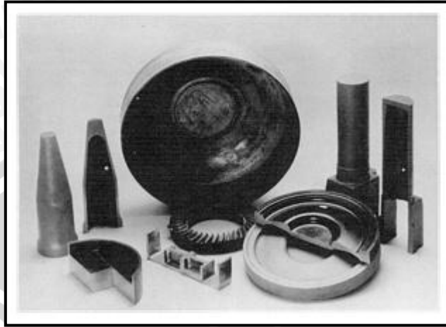
Gambar 2.3 Berbagai part yang dibuat menggunakan pengecoran squeeze . Sumber : Adam, 1998: 718
