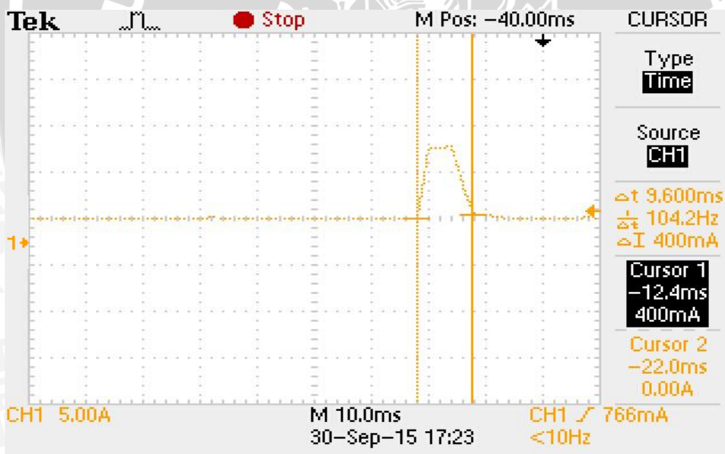
Gambar 5.19 Hasil pengujian hubung singkat zona 3
