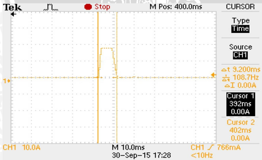
Gambar 5.17 Hasil pengujian hubung singkat zona 1
