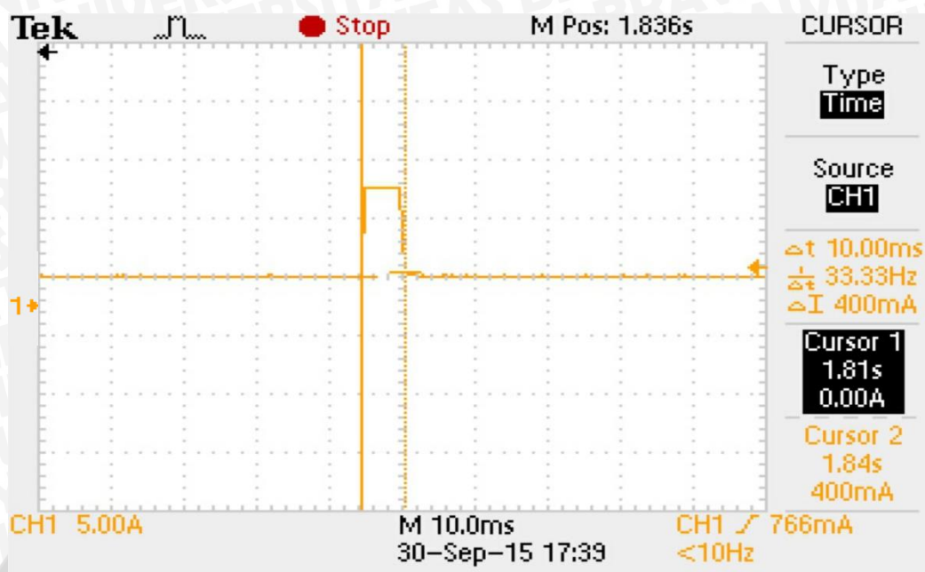
Gambar 5.20 Hasil pengujian hubung singkat zona 4
