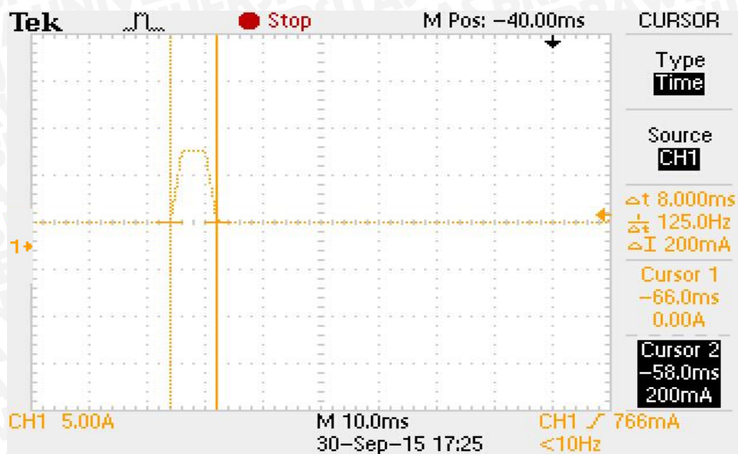
Gambar 5.18 Hasil pengujian hubung singkat zona 2
