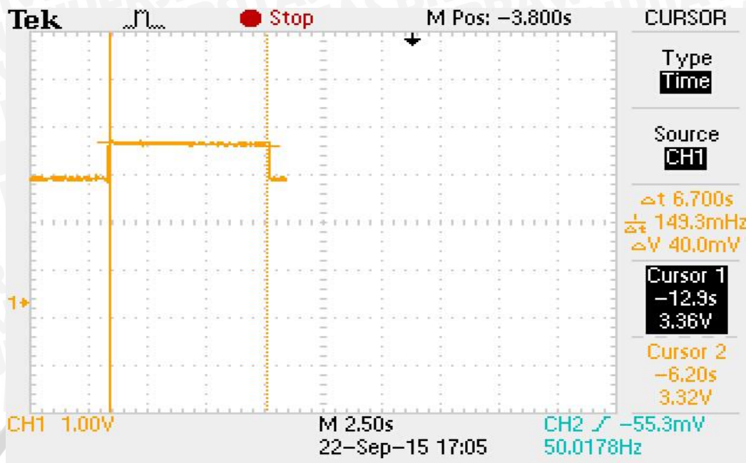
Gambar 5.14 Hasil pengujian beban lebih 6.2 A
