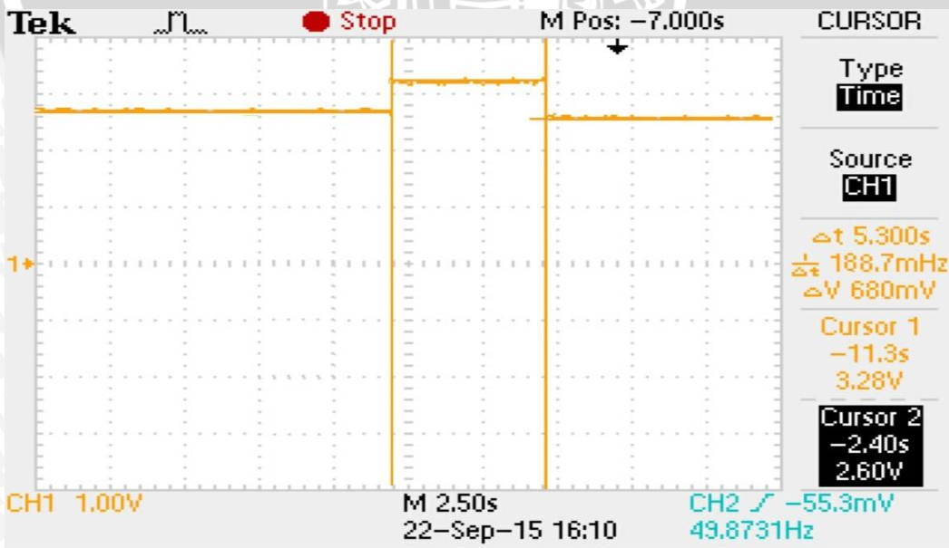
Gambar 5.15 Hasil pengujian beban lebih 7.3 A
