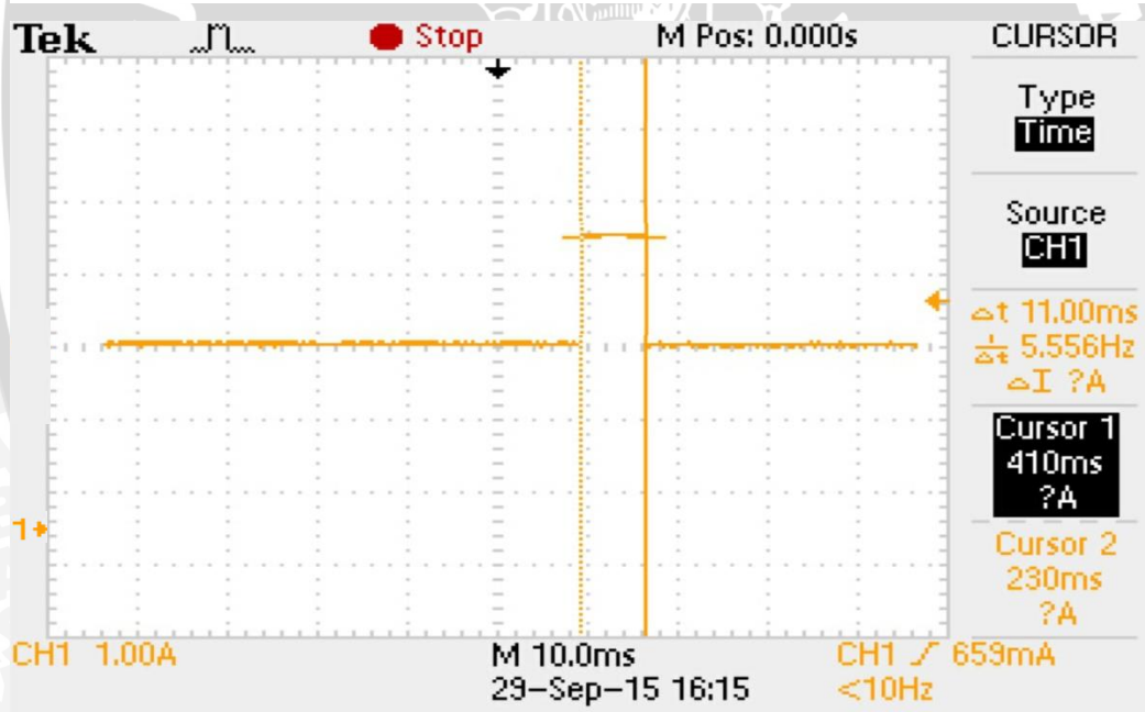
Gambar 5.21 Hasil pengujian hubung singkat zona 5
