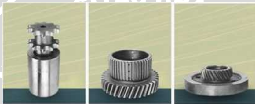
Gambar 2.11 Aplikasi las gesek pada paduan Al-Mg-Si Sumber : Manufacturing Technology INC
