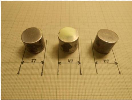
Spesimen uji kekerasan variasi *E-glass* 5wt%
