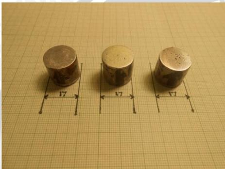
Spesimen uji kekerasan variasi *E-glass* 7,5wt%
