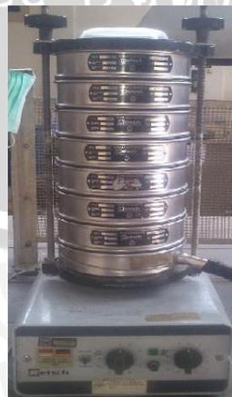
Gambar 3.6 Mesin Pengguncang Rotap
