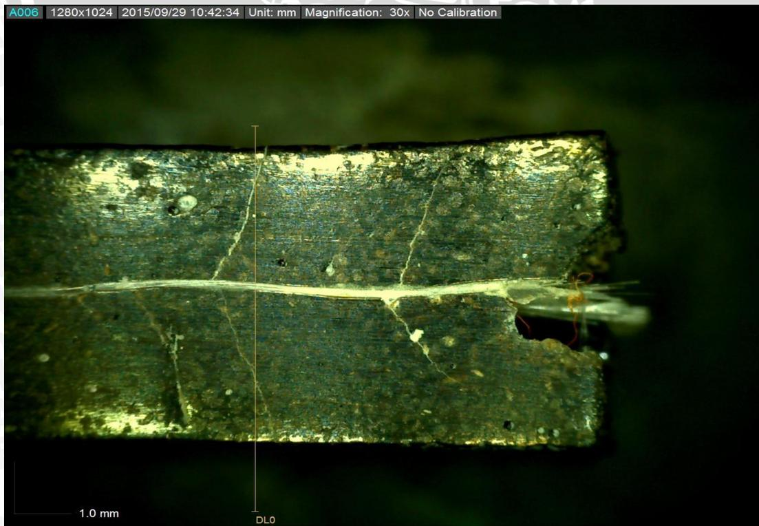
spesimen dengan *filler* 250 µm perbesaran 30x
