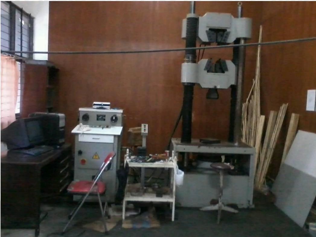
Gambar 3.2 Mesin uji tarik
