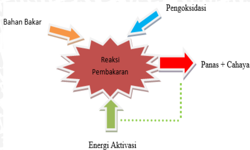
Gambar 2.1 Proses Pembakaran Sumber Wardana (2008:3)
