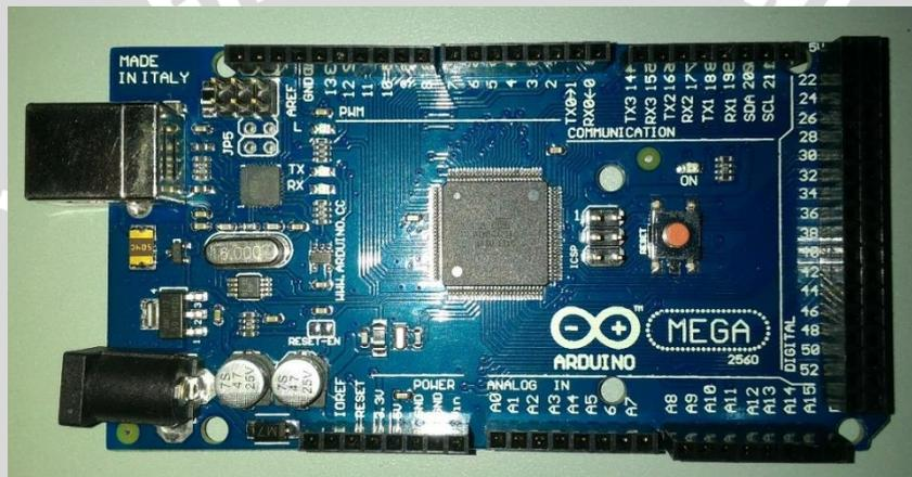
Gambar 4.10. Modul Arduino Mega 2560
