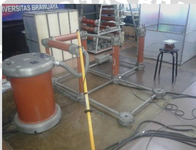
Gambar 10. Rangkaian pengujian Arus Konduksi pada pengukuran tegangan tinggi DC
