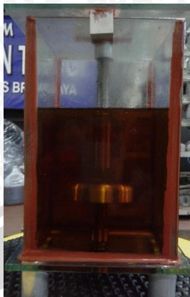
Gambar 12. Kondisi kotak uji ketika di masukkan minyak randu pada susunan elektroda Jarum-Piring
