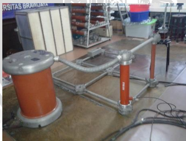
Gambar 11. Rangkaian pengujian Arus Bocor dan Tegangan Tembus pada pengukuran tegangan tinggi DC
