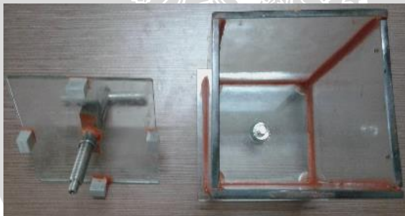
Gambar 5. Kotak uji untuk pengujian Arus bocor dan tegangan tembus tampak atas
