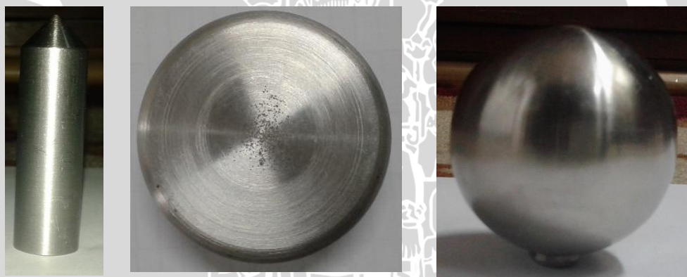
Gambar 13. Susunan elektroda jarum, piring, bola yang digunakan di dalam pengujian isolasi minyak randu
