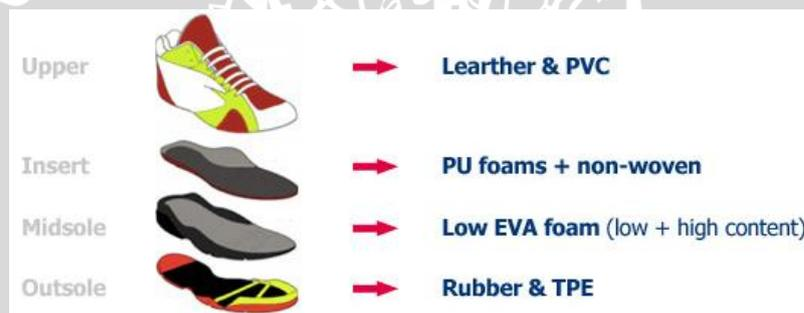
Gambar 2.6 Komponen penyusun sepatu
