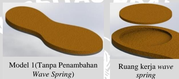
Gambar 4.12 Geometri *midsole* pada variasi model 1 dan model *midsole* dengan ruang kerja *wave spring*
