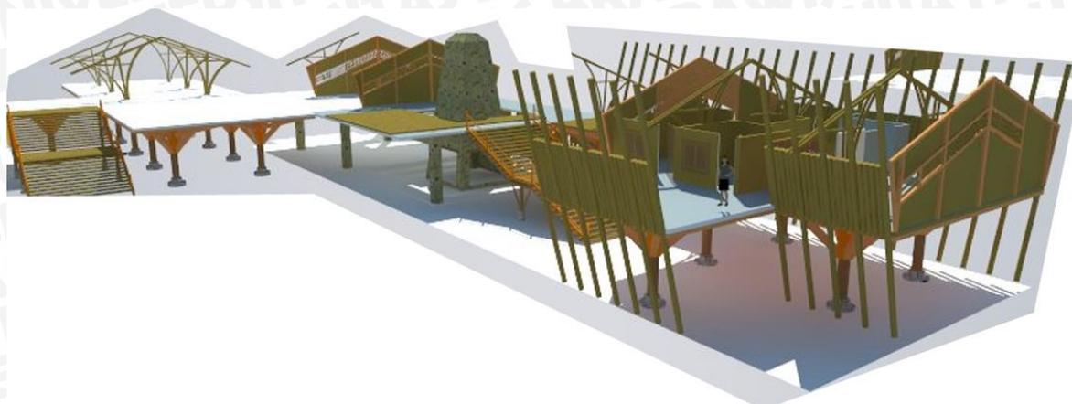
Gambar : 4.87. Dinding menggunakan Bilah bambu
