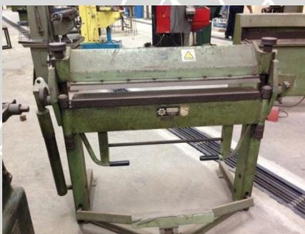
Gambar 3.5 Mesin Pemotong Plat
