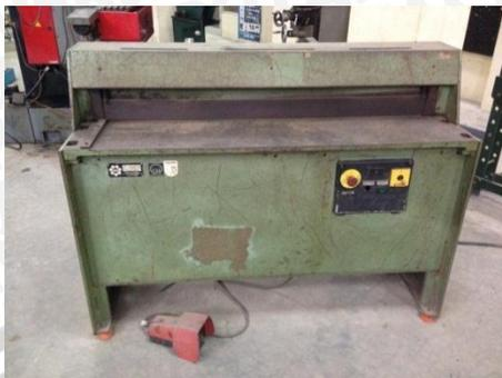
Gambar 3.4 Mesin Pemotong Plat
