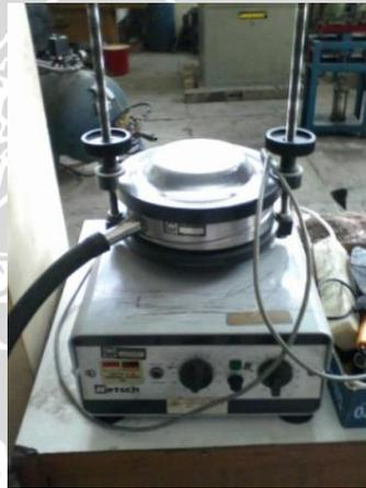
Gambar 3.8 Mesin Pengguncang Rotap
