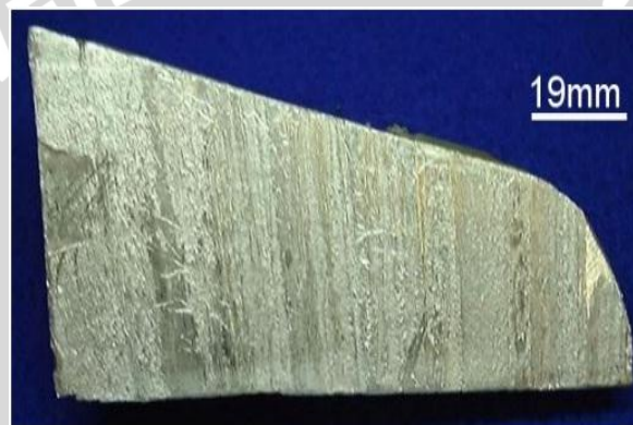
Gambar 2.5 Aluminium setelah dicetak dari tanur tanpa perlakuan Sumber: Anonymous 1 (2014)
