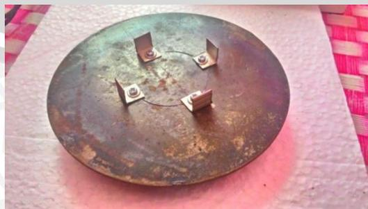
Gambar 4.4 Bentuk fisik piringan *spin coater*
