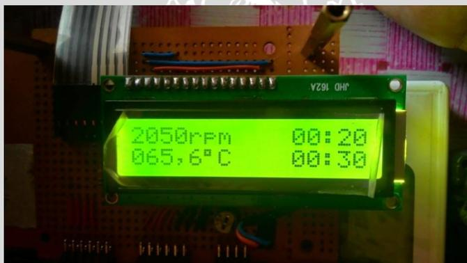
Gambar 4. Penampilan LCD 16x2 saat terjadi proses *spin coating*
