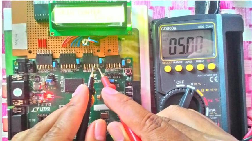
Gambar 5.1 Pengujian tegangan masukan dan keluaran pada rangkaian catu daya 5V dengan menggunakan multimeter
