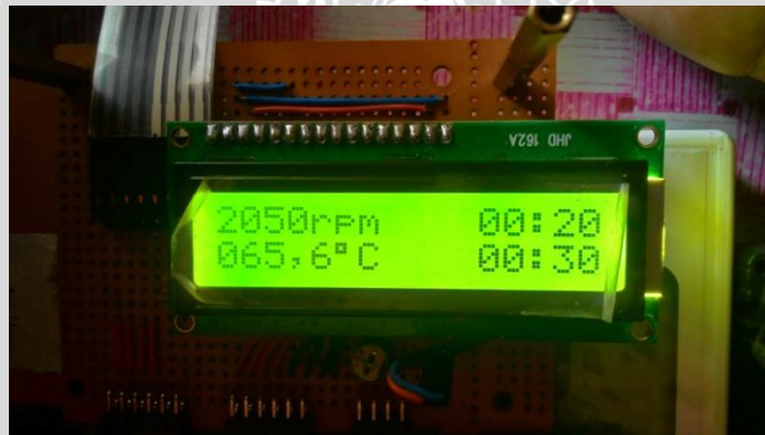
Gambar 4. Tampilan LCD 16x2 saat proses spin coating sedang dijalankan.
