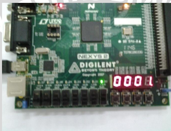
Gambar 5.2 Pengujian Input-Output pada Modul FPGA
