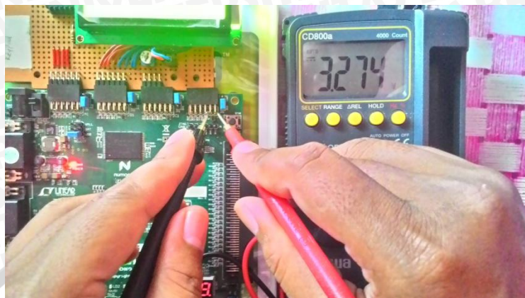
Gambar 5.1 Pengujian tegangan masukan dan keluaran pada rangkaian catu daya 3,3VDC dengan menggunakan multimeter
