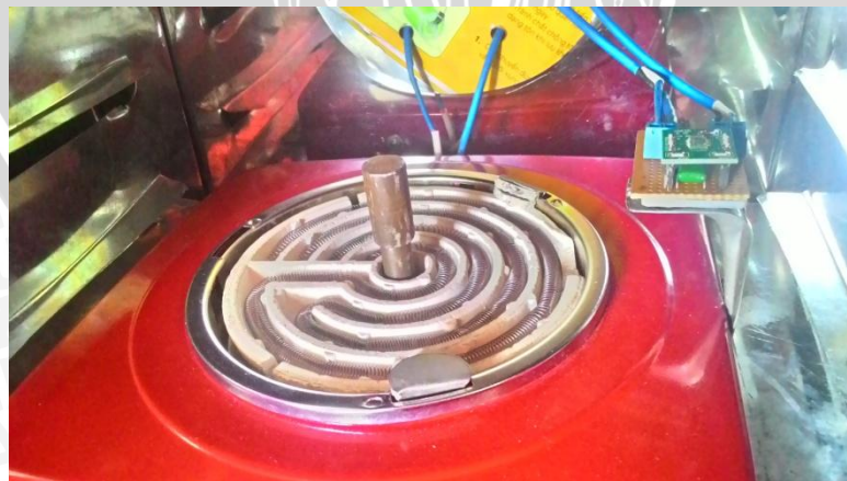
Gambar 2. Bagian dalam ruang spin coating (heater dan sensor SHT11)
