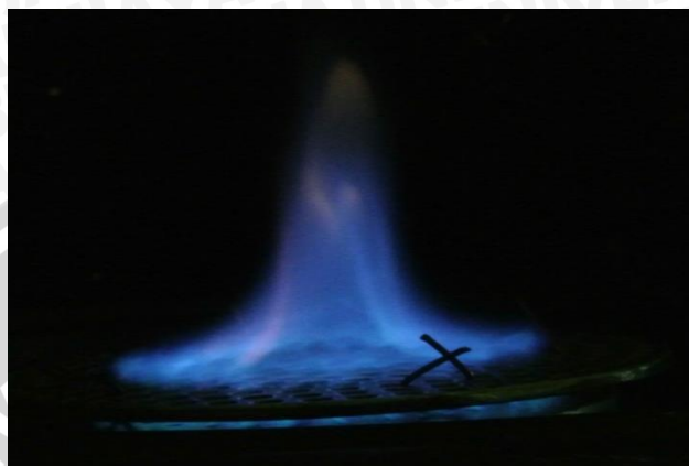
Gambar 4.4 Visualisasi api pada perforated burner dengan penambahan grid ketebalan 3 mm.
