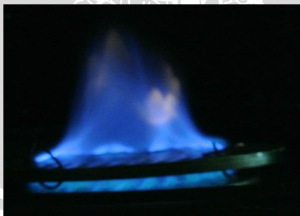
Gambar 4.5 Visualisasi api pada perforated burner dengan penambahan grid ketebalan 5 mm.
