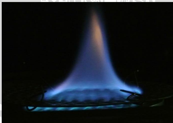
Gambar 4.3 Visualisasi api pada perforated burner dengan penambahan grid ketebalan 1 mm.
