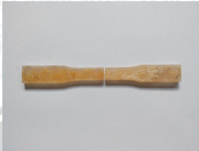
Gambar 4.1 Contoh Hasil Spesimen Uji Tarik
