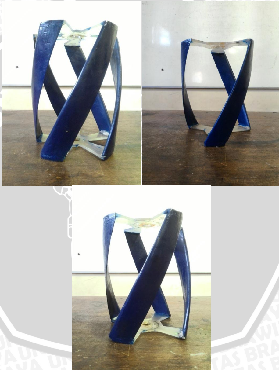
Gambar 3.5 Turbin Air Helikal Sudu 3, 4 dan 5 Sumber : Dokumentasi Pribadi
