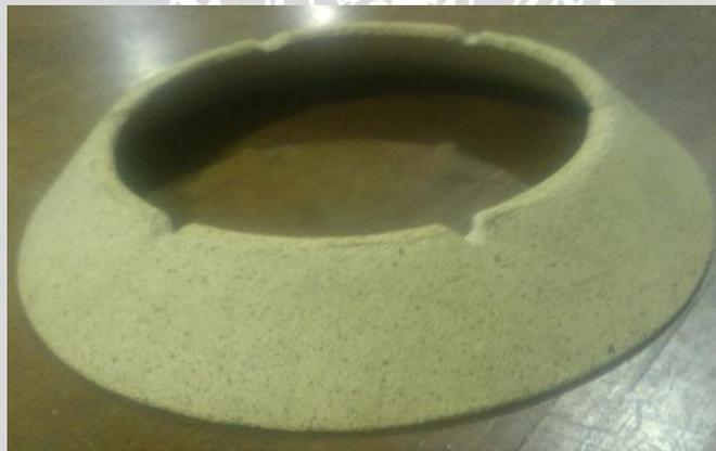
Gambar 3.5 Selubung dengan material keramik
