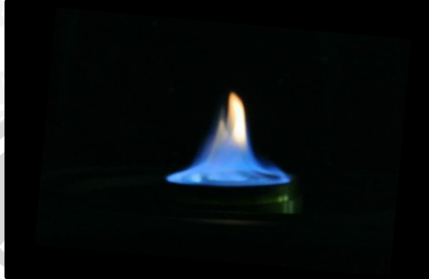
Gambar 4.1 Visualisasi api perforated burner tanpa menggunakan toroid
