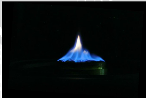
Gambar 4.3 Visualisasi api perforated burner menggunakan toroid 1 mm
