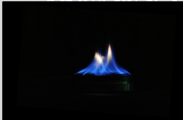
Gambar 4.2 Visualisasi api perforated burner menggunakan toroid 0,5 mm
