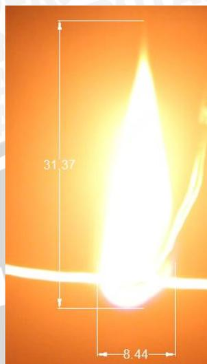
Gambar 4.6 Visualisasi api pembakaran sampel minyak dengan penambahan etanol 5%
