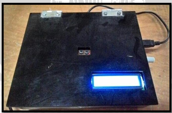
Foto Kotak Elektronik Pembangkit Pulsa Train
