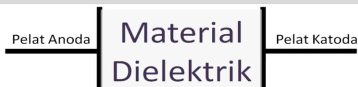
Gambar 2.11 Struktur dari Kapasitor Secara Elektrik
