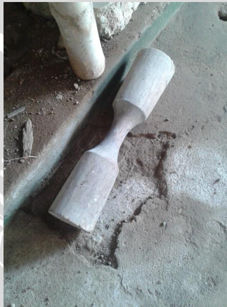
Gambar 4.6 Gemblong atau alu khusus yang dipukulkan pada kain batik ( nggemblong ) untuk melemaskan kain batik yang diklanj sebelumnya.
