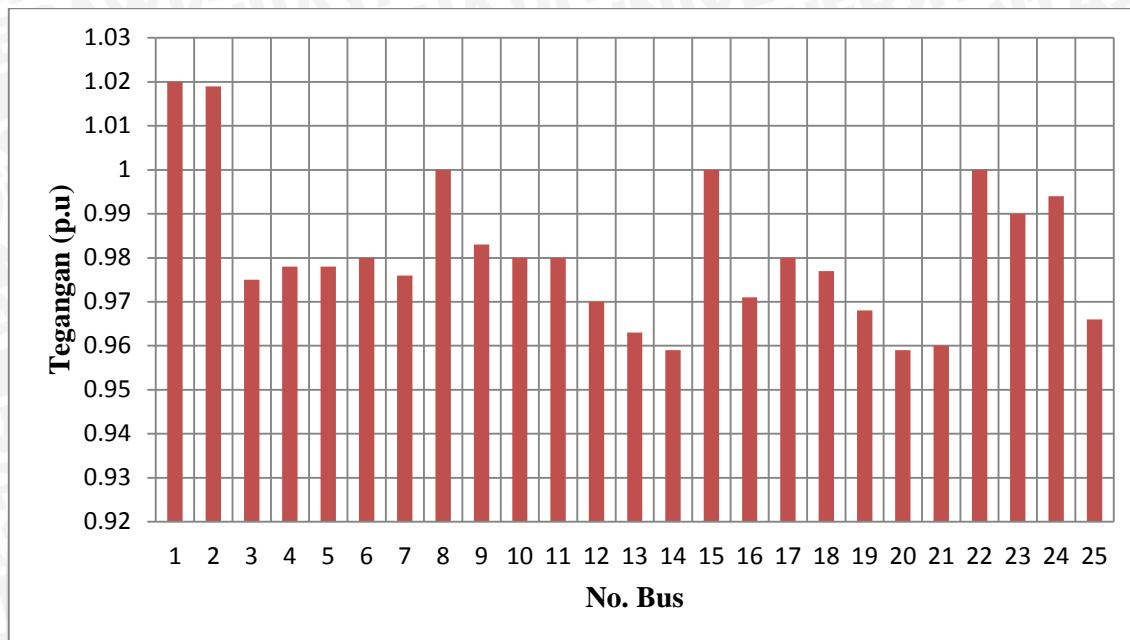
**Gambar 4.16.** Profil Tegangan pada Sistem Tenaga Listrik 500 kV Jawa - Bali Setelah Penempatan Kapasitor Bank
