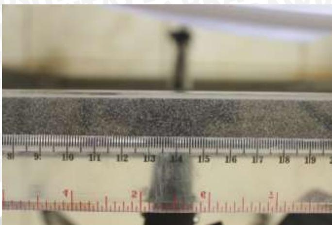
Gambar 4.2 Foto gelembung pada tekanan masuk 10 mmH<sub>2</sub>O (Re 1540)
