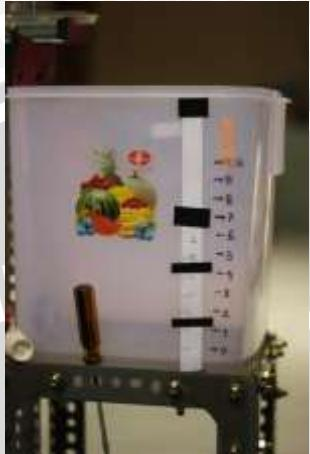
Gambar 3.3 Bak pengukur volume
