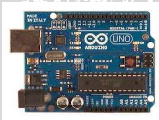
Gambar 2.9 Board Arduino UNO (sumber: arduino.cc, 2015)
