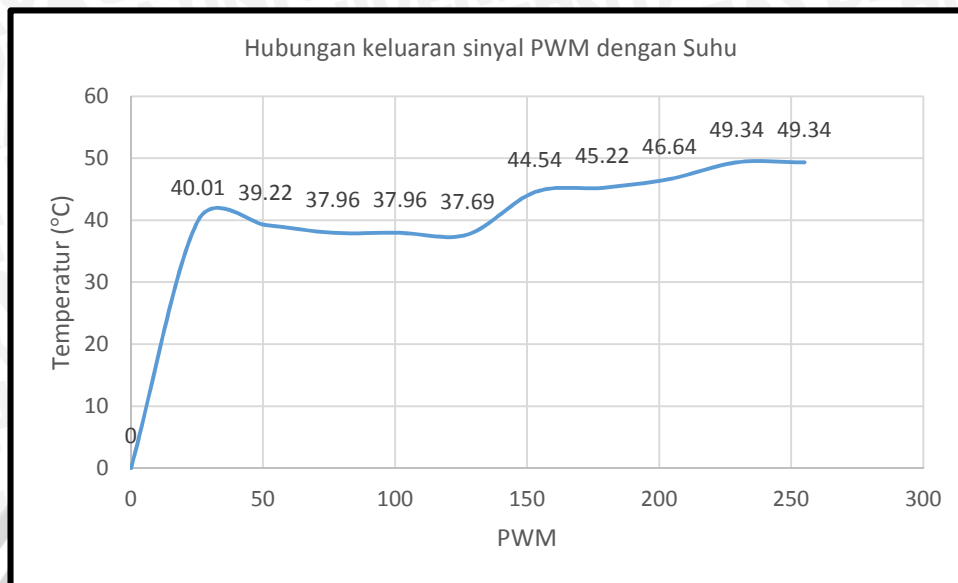
Gambar 5.4 Hubungan Sinyal PWM dengan Suhu (Perancangan)
