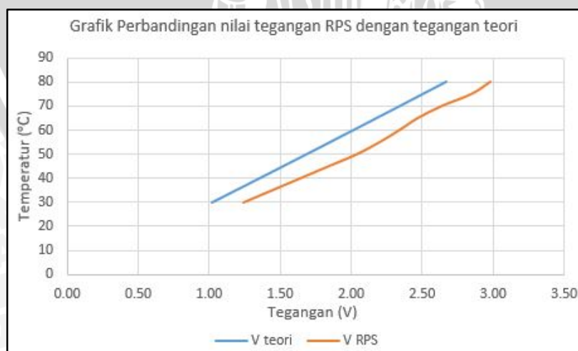
Gambar 5.3 Perbandingan Nilai V Pembacaan Suhu Pada Serial Monitor (RPS) dengan V Teori (Perancangan)
