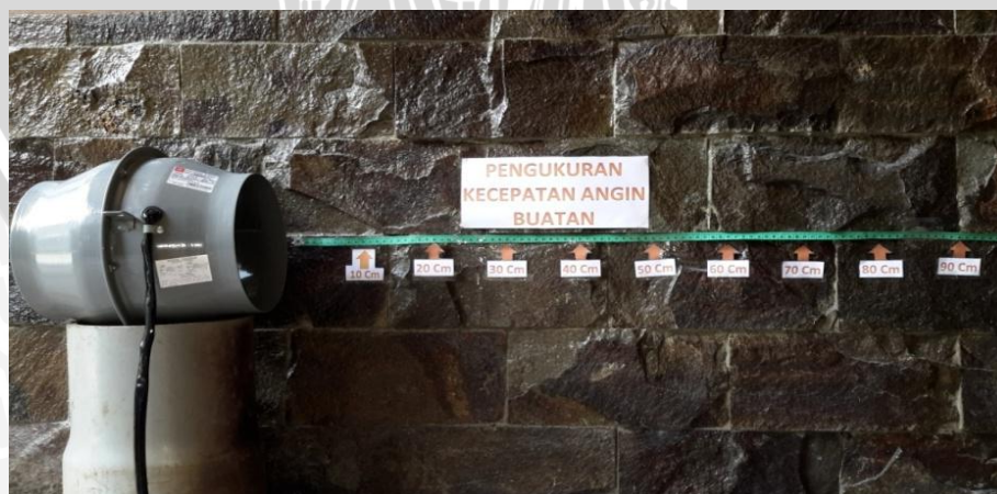
Gambar 4.2 Pengujian pengukuran variasi kecepatan angin dengan Anemometer
