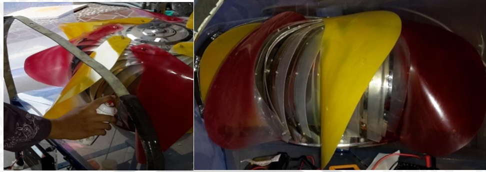
Gambar 4.7 Hasil penambahan dan pengecatan turbin siklon.
