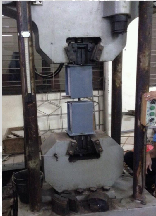
Gambar 4.1 Pengujian Tegangan Pull-out Bambu
