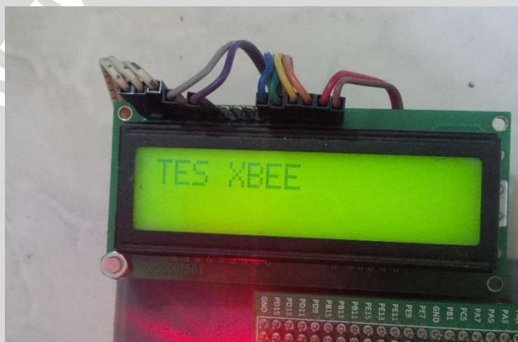
Gambar 5.9. Hasil Pengujian Komunikasi XBee pada LCD
