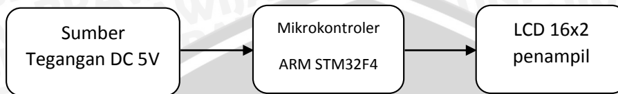
Gambar 5.3. Skema Pengujian LCD 16x2 karakter
