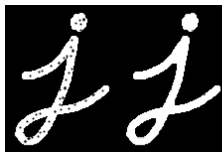
Gambar 2.5 Contoh citra dengan noise (kiri) dan setelah dilakukan proses closing (kanan)
