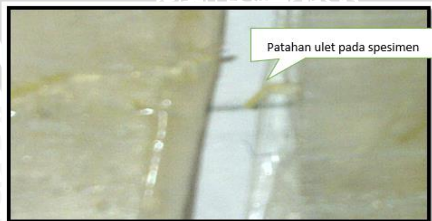
Gambar 4.7 Bentuk patahan spesimen uji bending dengan fraksi berat 10%
