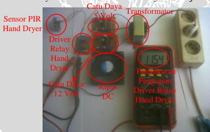
Gambar 5.3. Pengujian *Driver Relay Hand Dryer*
