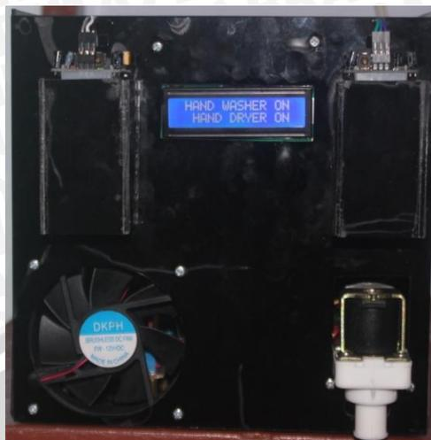
Gambar 5.8. Pengujian *Hand Washer* dan *Hand Dryer* Aktif
