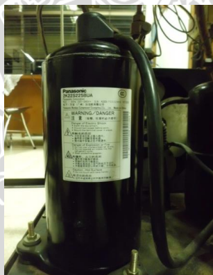
Gambar 2.5. Kompresor hermetik jenis rotari Sumber : Dokumentasi pribadi
