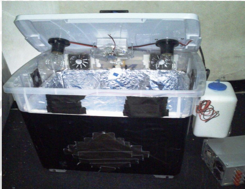
Gambar 1. Model Miniatur Box Sistem Pengendalian Suhu dan Kelembaban ekstraksi Metode Maserasi Minyak Atsiri Melati Tampak Samping Tutup Terbuka
