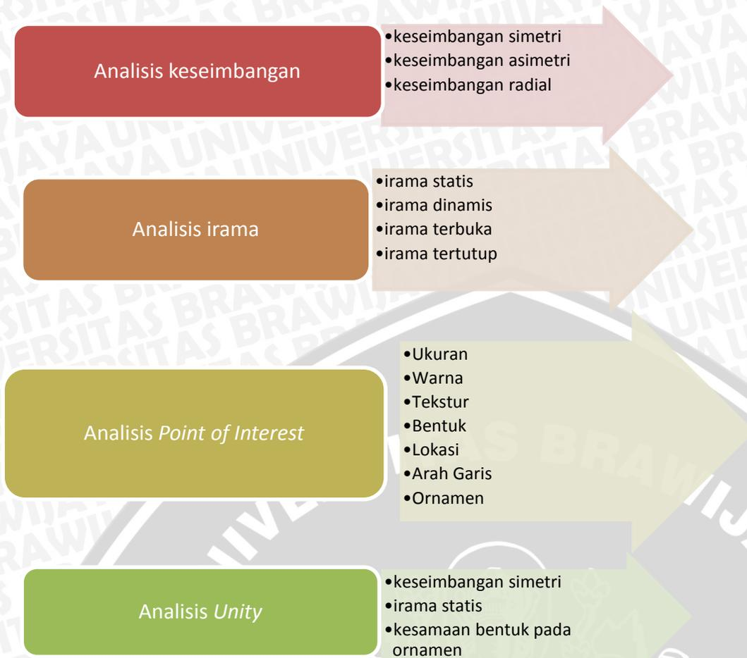
Gambar 3.2. Diagram analisis komposisi fasad
