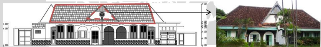
Gambar 4.629. Dormer pada rumah dinas P3GI nomor 37 dan 39
